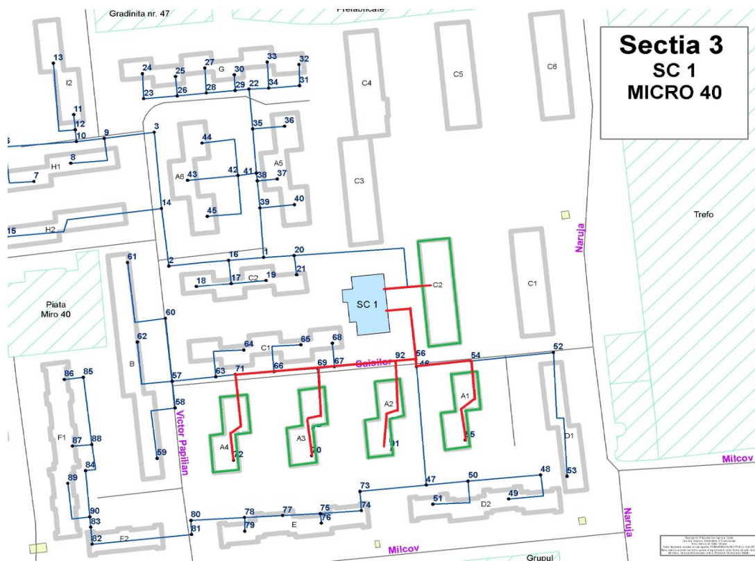
Figura 7 Traseul rețelelor secundare racordate la CT 1
