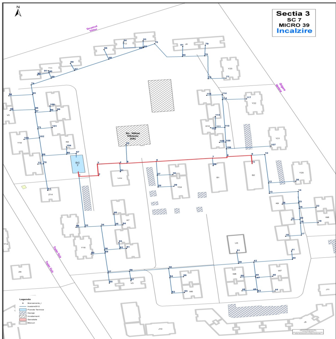
Figura 9 Traseul rețelelor secundare racordate la CT 7
